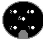
Abbildung 7: Pinbelegung: Einbaustecker / Kupplung für 5-Pol
