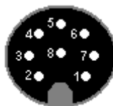
Abbildung 9: Pinbelegung: Einbaustecker / Kupplung für 8-Pol
