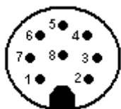
Abbildung 9: Pinbelegung: Einbaustecker / Kupplung für 8-Pol
