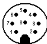
Abbildung 9: Pinbelegung: Einbaustecker / Kupplung für 8-Pol
