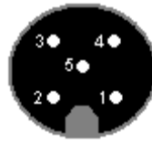
Abbildung 8: Pinbelegung: Einbaustecker / Kupplung für 5-Pol
