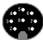
Abbildung 9: Pinbelegung: Einbaustecker / Kupplung für 8-Pol
