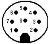
Abbildung 10: Pinbelegung: Einbaustecker / Kupplung für 8-Pol
