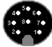
Abbildung 8: Pinbelegung: Einbaustecker / Kupplung für 8-Pol
