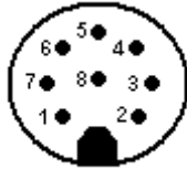
Abbildung 10: Pinbelegung: Einbaustecker / Kupplung für 8-Pol
