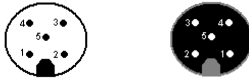
Abbildung 5: Pinbelegung: Einbaustecker / Kupplung für 5-Pol
