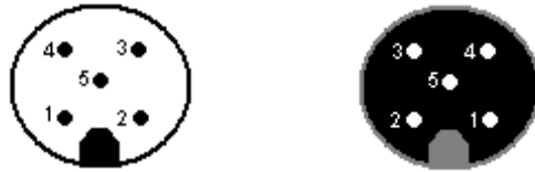
Abbildung 2: Pinbelegung: Einbaustecker / Kupplung für 5-Pol
